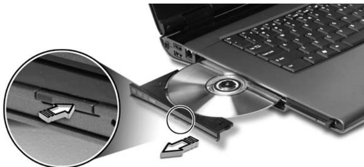
Introduza um clipe no orifício de ejeção de emergência para ejectar o tabuleiro da unidade óptica quando o computador está desligado.
