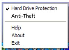
A selecção desta função estaciona as cabeças do disco rígido (HDD) no caso de ser detectado qualquer movimento ou vibração que ultrapasse o nível tolerado pelo disco rígido.
