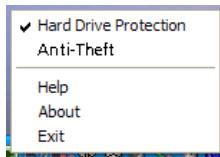
Po zvolení tejto funkcie sa hlavy HDD v prípade zistenia nejakej vibrácie alebo pohybu, ktorý prekračuje prípustnú úroveň, zaparkujú.
