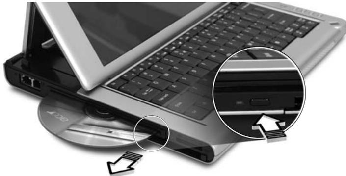
Com a alimentação desligada, é possível ejectar o tabuleiro da unidade utilizando o furo de ejecção de emergência.
