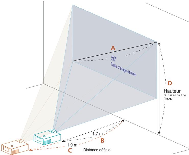
Le tableau ci-dessous explique la façon d'obtenir une taille d'image désirée en réglant soit la position soit la bague de réglage du zoom.
