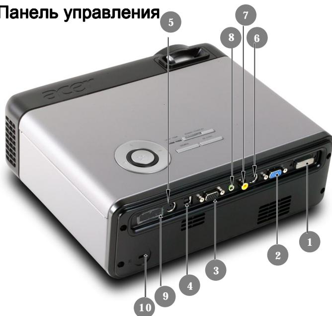
1. Входной разъем DVI-I (для цифрового сигнала высокой четкости с функцией защиты от копирования HDCP)(Дополнительно)
