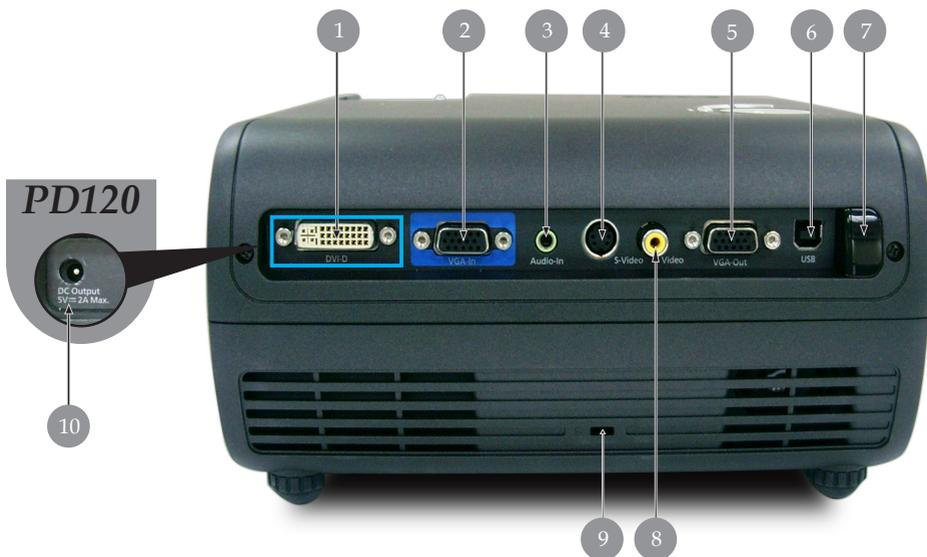
1. DVI-Eingang (für Digitalsignal mit HDCP-Funktion)
