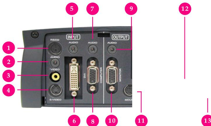
1. Conector de Entrada de RS232 (El "RS232" es sólo para el propósito del servicio)
