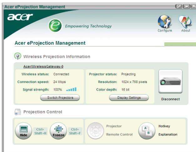
L'applicazione rileverà automaticamente i WPG disponibili. Ciascun WPG è identificato dall'indicatore "AcerProjector" nell'identificatore SSID. Se il proiettore è installato in una posizione fissa, si può anche scegliere di assegnare un SSID specifico a quel proiettore, indicando, ad esempio, il numero della stanza in cui è installato il proiettore (fare riferimento alla sezione "Configurazione", più avanti in questa Guida).
