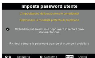
Il proiettore mette a disposizione due opzioni per la “Modalità di protezione”.
