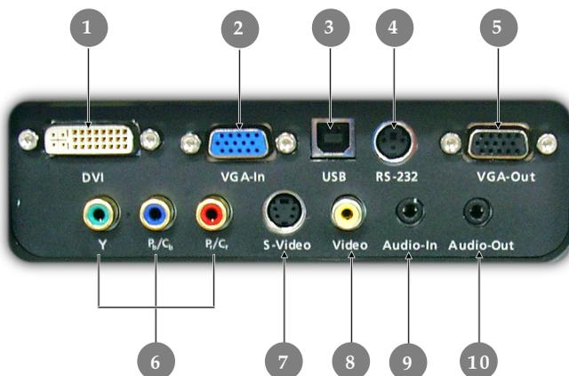
1. DVI-I-Eingangsbuchse (PC Digital- und Analogsignal/HDTV/ HDCP/Component-Videoeingang)
