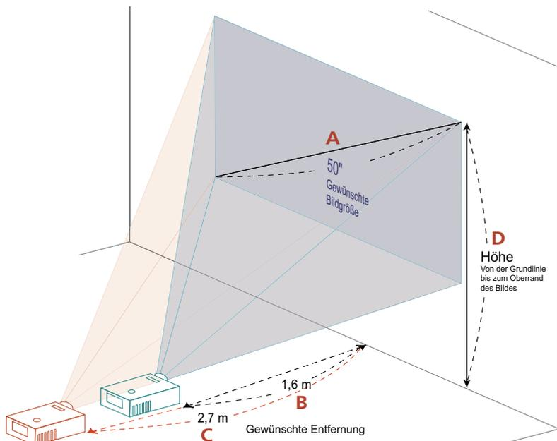
Die folgende Tabelle zeigt an, wie Sie eine gewünschte Bildgröße durch Justieren der Projektorposition oder durch Verwenden des Zoomrings erreichen. Wenn Sie z.B. Um eine Bildgröße von 50 Zoll zu erhalten, stellen Sie den Projektor in einer Entfernung von 1,6 bis 2,7 m von der Leinwand auf und justieren Sie entsprechend den Zoomfaktor.
