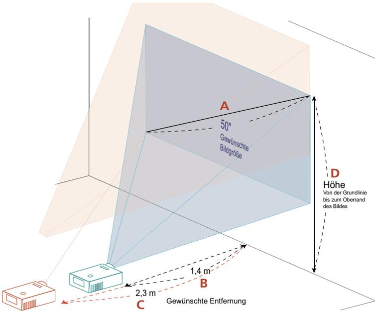
Die folgende Tabelle zeigt an, wie Sie eine gewünschte Bildgröße durch Justieren der Projektorposition oder durch Verwenden des Zoomrings erreichen. Wenn Sie z.B. Um eine Bildgröße von 50 Zoll zu erhalten, stellen Sie den Projektor in einer Entfernung von 1,4 bis 2,3 m von der Leinwand auf und justieren Sie entsprechend den Zoomfaktor.
