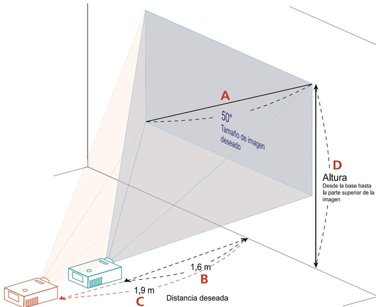
La tabla que aparece abajo muestra cómo lograr el tamaño de imagen deseado ajustando la posición o el anillo del zoom. Ejemplo: Para lograr un tamaño de imagen de 50", coloque el proyector a una distancia entre 1,6 metros y 1,9 metros de la pantalla y ajuste el nivel de zoom en forma apropiada.
