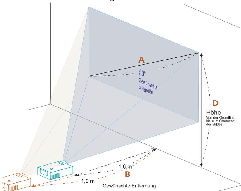
Die folgende Tabelle zeigt an, wie Sie eine gewünschte Bildgröße durch Justieren der Projektorposition oder durch Verwenden des Zoomrings erreichen. Wenn Sie z.B. eine Bildgröße von 50" haben möchten, dann platzieren Sie bitte den Projektor 1,6 m bis zu 1,9 m von der Leinwand entfernt und justieren entsprechend den Zoomfaktors.
