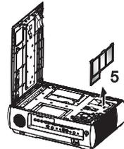
Gehen Sie in umgekehrter Reihenfolge vor, um die Staubfilter zu installieren.
