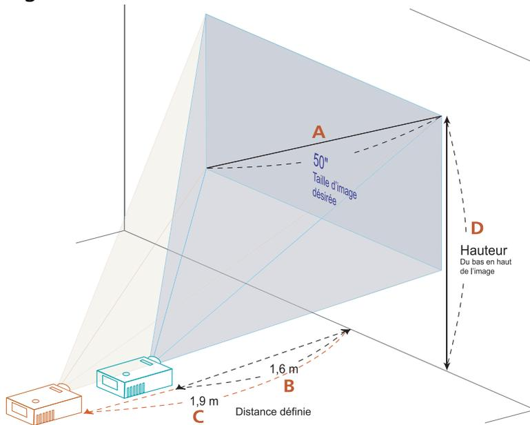
Le tableau ci-dessous explique la façon d'obtenir une taille d'image désirée en réglant soit la position soit la bague de réglage du zoom. Par exemple: Pour obtenir une taille d'image de 50 pouces, réglez le projecteur sur une distance de 1,6 m à 1,9 m de l'écran et réglez le niveau du zoom en fonction.
