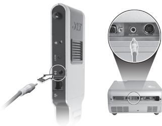
3. Controllare il LED d'alimentazione sulla sinistra del WPG. Se il LED è spento, collegare una estremità del cavo DC-DC al collettore s'alimentazione e l'altra estremità al connettore DC-out 5 V del proiettore (se adatto), oppure usare l'adattatore di corrente 5 V per fornire l'alimentazione. Una volta che l'alimentazione è collegata, il LED si deve accendere di colore rosso.
