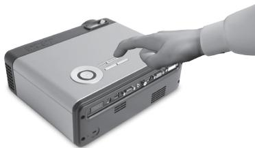
2. 必要なら、DVI-to-VGAコンバータを使って、Acer WPGを接続してください。オーディオケーブルの一方の端をプロジェクタのオーディオインジャックに差し込み、もう一方の端をAcer WPGのオーディオジャックに差し込みます。
