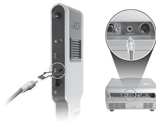
3. WPG左側の電源LEDを確認してください。LEDが点灯していない場合、DC-to-DCケーブルを使って電源ジャックとプロジェクタの5V DC出力ジャック（適合する場合）を接続するか、5Vの電源アダプタを使って電源を供給してください。電源が供給されると、電源LEDが赤色に点灯します。
