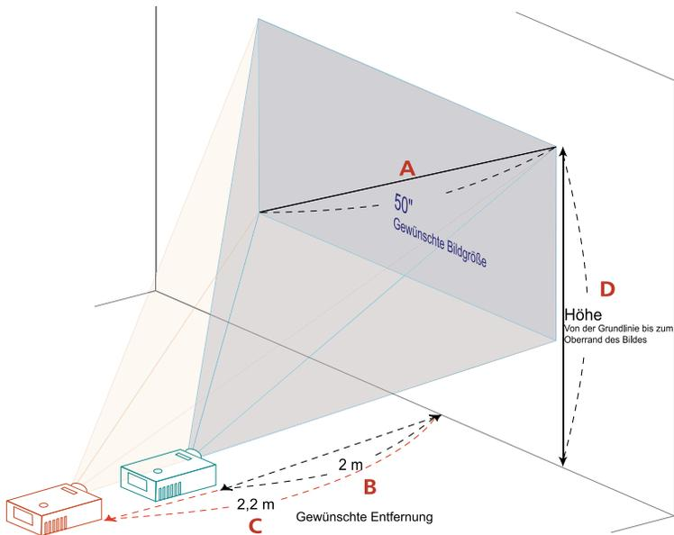
Die folgende Tabelle zeigt an, wie Sie eine gewünschte Bildgröße durch Justieren der Projektorposition oder durch Verwenden des Zoomrings erreichen. indem Sie z.B. auf Um eine Bildgröße von 50 Zoll zu erhalten, stellen Sie den Projektor in einer Entfernung von 2 bis 2,2m von der Leinwand auf und justieren Sie entsprechend den Zoomfaktor.
