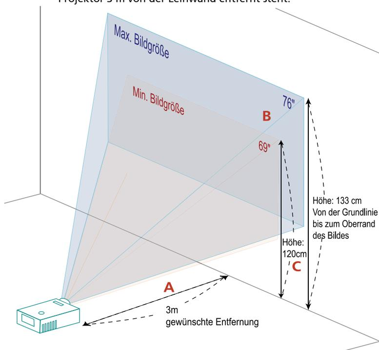
**Abbildung:** Feste Entfernung mit unterschiedlichen Zoomfaktoren und Bildgrößen. (Nur für X1260 Serie, X1160 Serie ist mit fixiertem Objektiv ausgestattet.)
