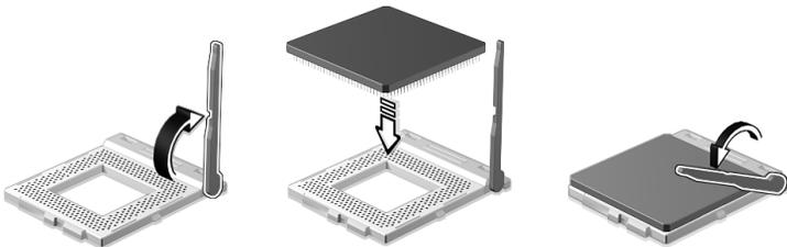
3. Befestigen Sie eine Seite des Metallhalters vom Ventilator/Kühlkörper am CPU-Sockel und drücken Sie dann die andere Seite des Metallhalters vorsichtig nach unten, bis er einrastet.
