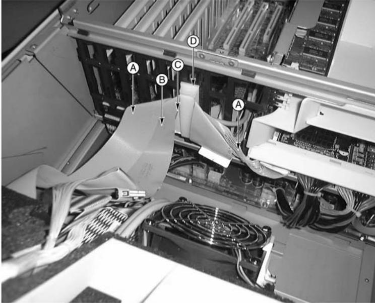
Abbildung 10 - Vordere Kabel in der Kabelklemme
