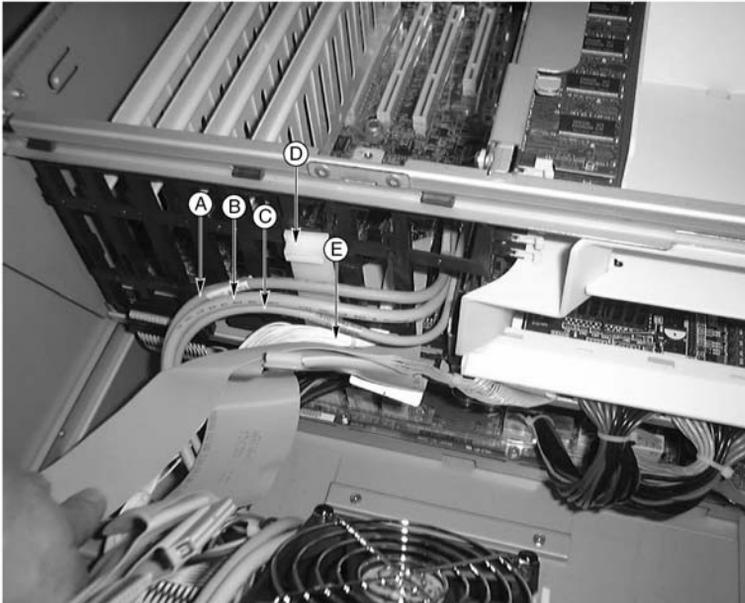
Abbildung 11 - Rückseitige Kabel in der Kabelklemme
