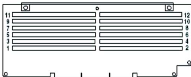
Figura 26 - Ordine di installazione corretto dei moduli DIMM
