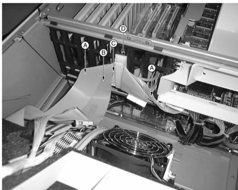
Figura 10 – Cavetti anteriori nel morsetto serrafilo.
