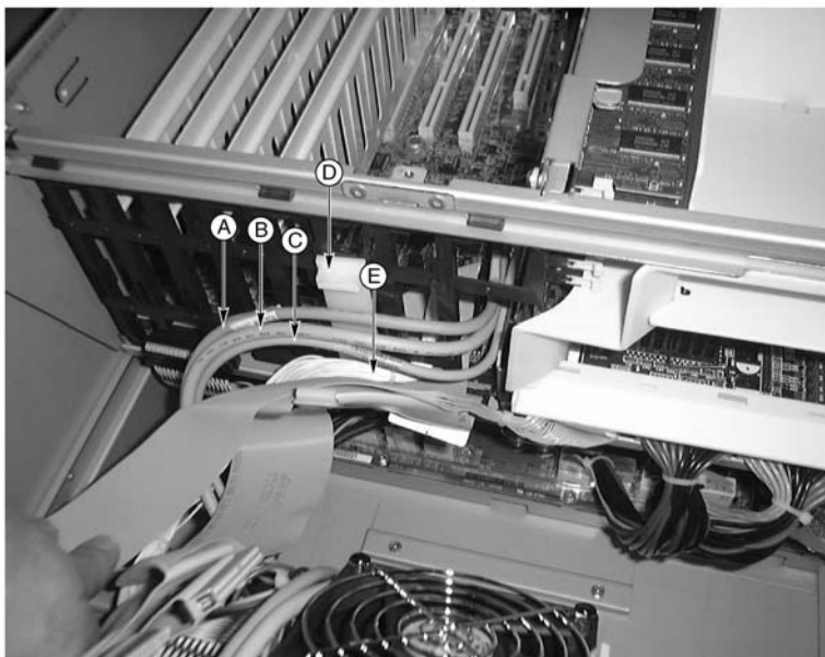
Figura 11 – Cavetti posteriori nel morsetto serrafilo.
