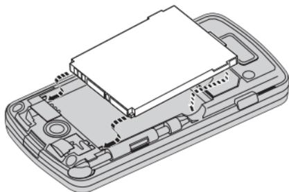
Insérez les onglets sur la base du couvercle du compartiment batterie dans les guides de votre Smartphone. Déplacez soigneusement le couvercle jusqu'à ce qu'il se clipse en place.
