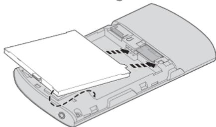
Führen Sie die Zungen unten am Akkudeckel in die entsprechenden Öffnungen im Telefon. Drücken Sie vorsichtig oben auf den Deckel, bis die Klemmen an den Seiten des Deckels einrasten.
