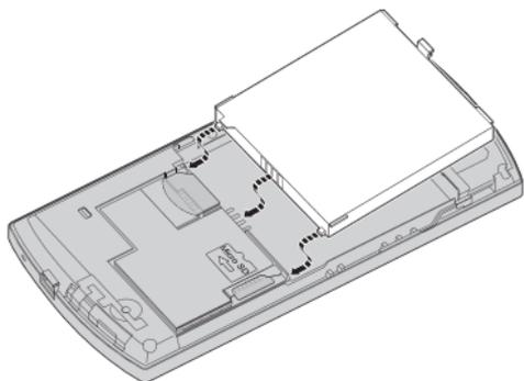
Insérez les onglets sur la base du couvercle du compartiment batterie dans les logements du Smartphone.
