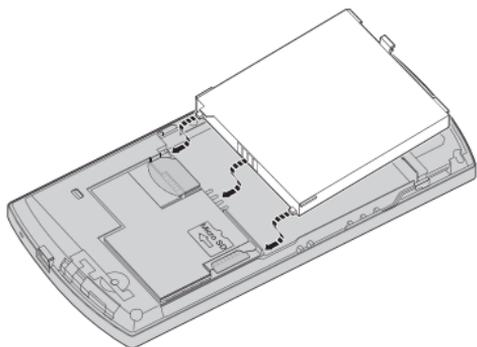
Inserire le linguette presenti sul fondo del coperchio della batteria negli alloggi dello smartphone.
