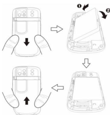
Refermez le couvercle de la batterie en le faisant glisser jusqu'à ce qu'il s'attache automatiquement.
