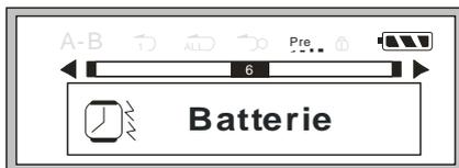
Wenn keine Operation bei der Einstellung vorhanden ist, wird das Gerät automatisch ausgeschaltet. Bitte betreten Sie die Batterieeinstellungsmenü. Hier können Sie die automatische Schaltzeit auswählen.
