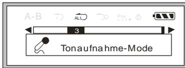
Mit Drücken der Menütaste kann man den Aufnahmezustand wählen und die Aufnahme starten. Mit der Pause-Taste kann man die Aufnahme aussetzen.
