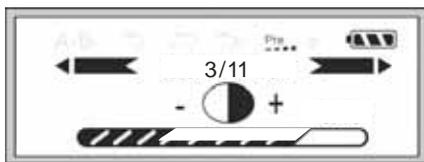
Schieben Sie in der Einstellungsmodus die Menütaste an die Rechtsseite oder Linksseite, um Kontrast auszuwählen. Und drücken Sie die Menütaste, um die Kontrastmode zu betreten. Schieben Sie die Menütaste an die Rechtsseite oder Linksseite und den Kontrast mit der Menütaste zu bestätigen.
