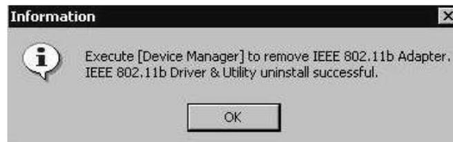
4. Das System zeigt eine Nachricht wie unten abgebildet während der „Geräte-Manager“ hochfährt. Folgen Sie der Anweisung, um den IEEE802.11b WLAN Adapter zu deinstallieren.
