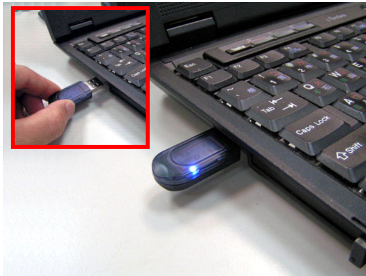
Figure 2-10: Branchez l'adaptateur USB Bluetooth sur le port USB de votre PC portable.
