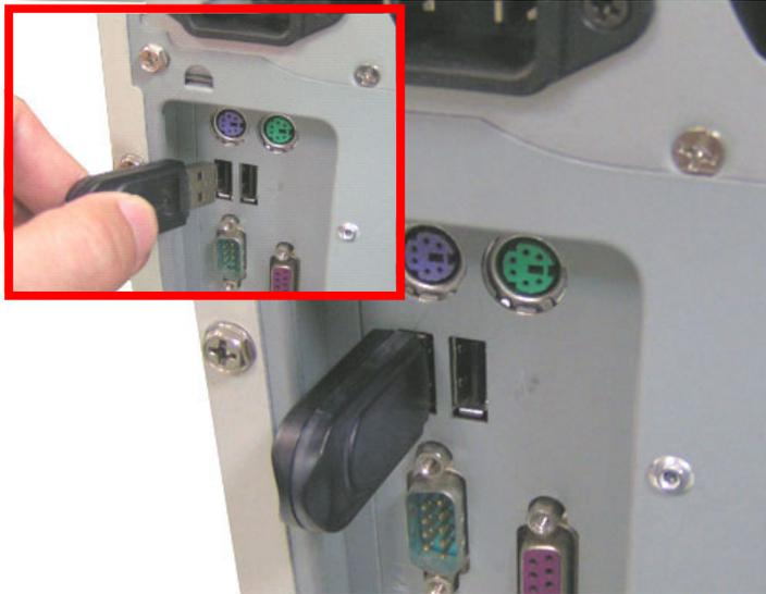
*Figura 2-9: Conecte el Adaptador USB de Bluetooth en el Puerto USB en la PC de escritorio*
