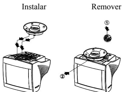
Figura 1 Como instalar e remover a base giratória
