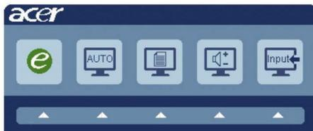
Drücken Sie zum Öffnen des Schnellzugriff-Menüs die Funktionstaste. Über das Schnellzugriff-Menü können Sie die gebräuchlichsten Einstellungen sehr schnell auswählen.
