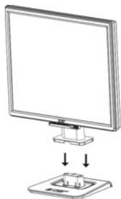
Figura 1 Instalarea și scoaterea bazei pivotante
