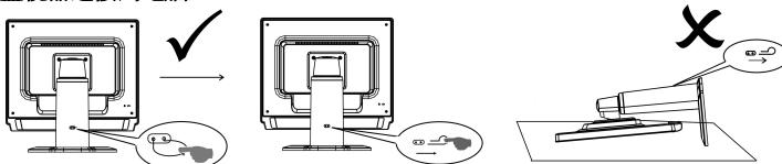
依上圖所示，將顯示器支架處的插銷拔出。然後可進行高度調整，請注意在拔插銷時將機器立在桌上防止顯示器頂部彈起。
