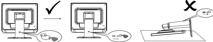
Ziehen Sie den Stift wie in den Abbildungen angezeigt aus dem Stützrahmen des Bildschirms heraus und verstellen Sie dann die Höhe. Achten Sie beim Herausziehen des Stiftes darauf, dass das Gerät aufrecht auf dem Tisch steht, damit das Oberteil des Bildschirms nicht herausfällt.
