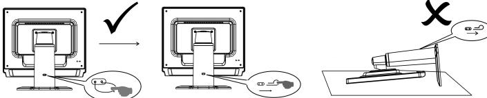
Извлеките штифт из каркаса, поддерживающего дисплей, как показано на рисунке, и отрегулируйте высоту. Учтите, что при извлечении штифта следует поднять аппарат – в противном случае дисплей может выскошлынуть.
