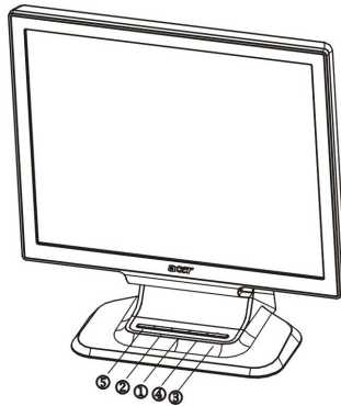
図 3 外部コントロールボタン
