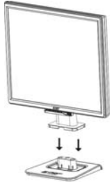
Figur 1 Montering og afmontering af Swivel Basen
