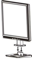
Figure 1 Installation et démontage de la Base Pivotante Support (pour AL1917 h/AL1917 r uniquement)
