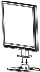
Abb. 1 Anbringen und Entfernen des Fußes Stützrahmen(nur AL1917 h/AL1917 r)
