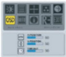
Здесь вы можете настроить положение экранного меню на экране. Функция TIMEOUT позволяет установить время автоматического выхода из экранного меню в диапазоне от 10 до 120 сек.
