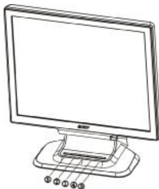
Εικόνα 3 Κουμπί Εξωτερικού Ελέγχου
