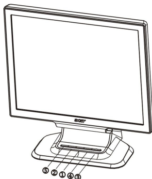
図 3 外部コントロールボタン
