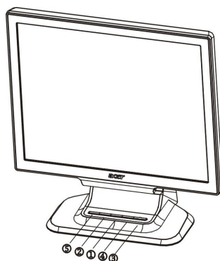
Рис. 3. Наружные кнопки управления
