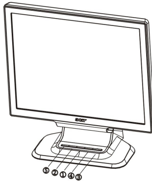
Figura 3 Botón de control externo
