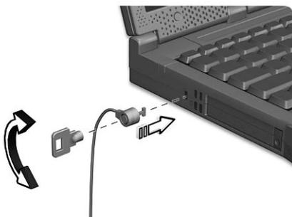
Enroulez le câble du cadenas de sécurité pour ordinateur autour d'une table, de la poignée d'un tiroir verrouillé, ou de tout autre objet fixe. Insérez le cadenas dans l'encoche et tournez la clef pour verrouiller le cadenas. Certains modèles ne possèdent pas d'encoche.
