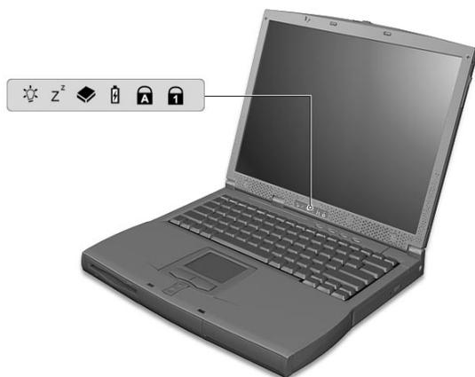
Le icone di stato relative alla modalità alimentazione (Power) e sospensione (Sleep) sono visibili anche quando il coperchio del display è chiuso, al fine di consentire il controllo dello stato del computer.
