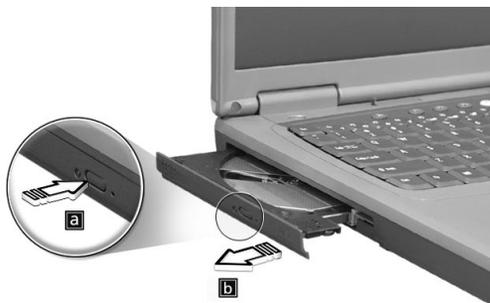
Wenn der Computer ausgeschaltet ist, können Sie den Laufwerksträger über das Notauswurfloch ausfahren. Siehe Seite 53.
