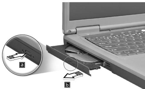
Quando il computer è spento, è possibile espellere il vassoio dell'unità utilizzando il foro di espulsione di emergenza. Vedere pagina 53.
