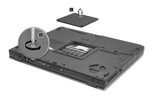
3 Insérez le module mémoire en diagonale dans le connecteur (a), puis appuyez doucement sur le module (b) jusqu'à ce qu'il se mette en place avec un déclic.
