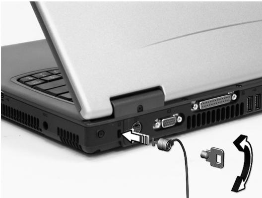
Enrole um cabo de bloqueio de segurança do computador em torno de um objecto imóvel, como por exemplo uma mesa ou o puxador de uma gaveta fechada. Introduza o bloqueio na ranhura da chave de protecção de segurança e rode a chave para proteger o bloqueio. Também estão disponíveis modelos sem chave.
