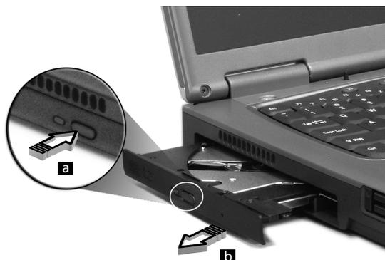
Quando a corrente está desligada, pode ejetar o tabuleiro da unidade utilizando o orifício de ejeção de emergência. Consultar página 50.
